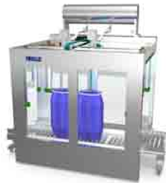
自动灌装(灌装区域密闭微负压，顶部有排风口，废气接至处理设施内)
